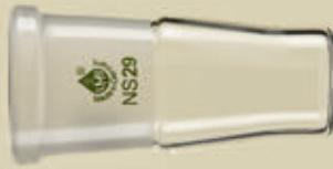
mit Kegelschliffhülse und Olive,
