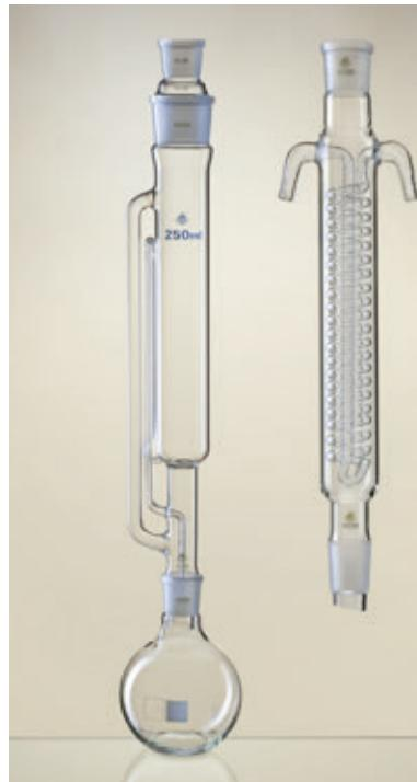
**Extraktor nach Soxhlet**, mit Kegel-
