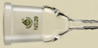
mit Kegelschliffhülse und Olive, 90°,
