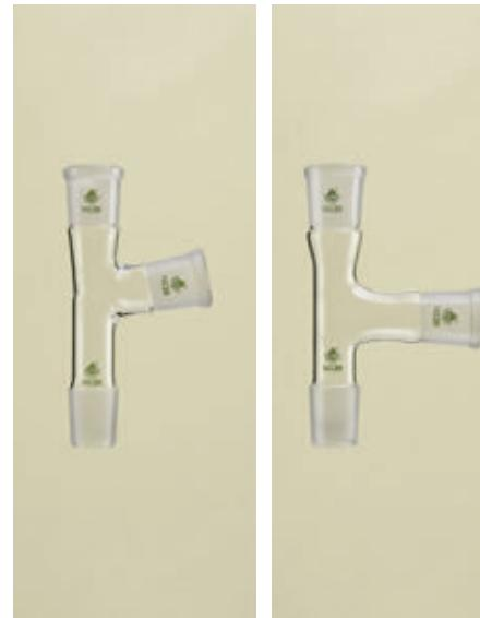
mit 2 parallelen Hälsen, 2 Kegelschliffhülsen und einem Kegelschliffkern gleicher Größe, Borosilikatglas 3.3
